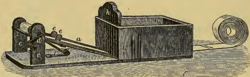
Einfacher Apparat zur Herstellung von Gipsbinden. }
