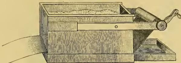
Apparat von Wywodzew zur Herstellung von Gipsbinden.
