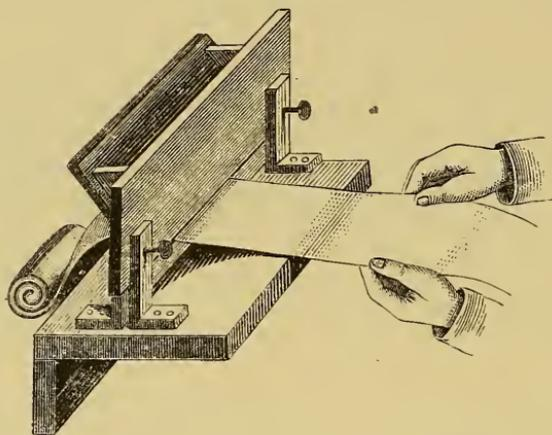
Pflasterstreichmaschine speziell für Heftpflaster.
