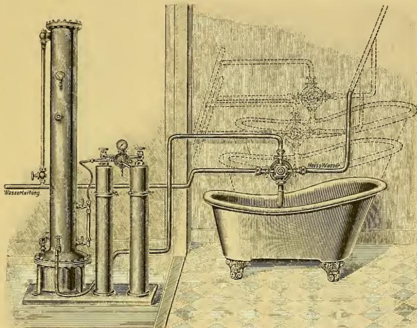
Vorrichtung zur Herstellung von Kohlensäurebädern mit Hilfe käuflicher verflüssigter
