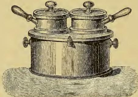
Wasserbad mit Dampfheizung für Infuse und Dekokte.
