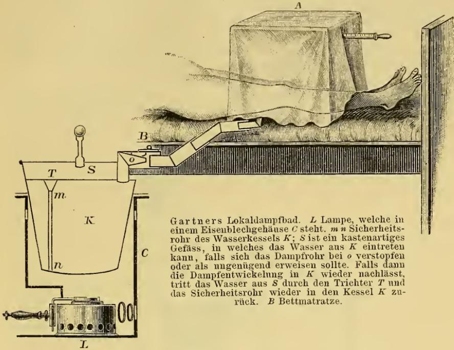
Gartners Lokaldampfbad. *L* Lampe, welche in einem Eisenblechgehäuse *C* steht. *m* *n* Sicherheitsrohr des Wasserkessels *K*; *S* ist ein kastenartiges Gefäß, in welches das Wasser aus *K* eintreten kann, falls sich das Dampfrohr bei *o* verstopfen oder als ungenügend erweisen sollte. Falls dann die Dampfentwicklung in *K* wieder nachlässt, tritt das Wasser aus *S* durch den Trichter *T* und das Sicherheitsrohr wieder in den Kessel *K* zurück. *B* Bettmatratze.
