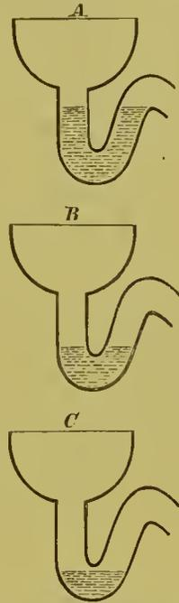
Fig. 100. Verschiedene Füllungen der Syphons. A normaler, gefüllter Syphon. B geschwächter Syphon. C leer gezogener Syphon.
