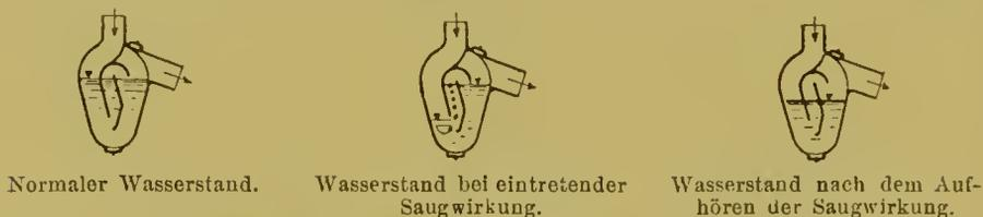
Fig. 102. Nicht leersaugbarer Geruchsverschluß System KESSELRING ( $\frac{1}{10}$ — $\frac{1}{20}$  nat. Gr.).
