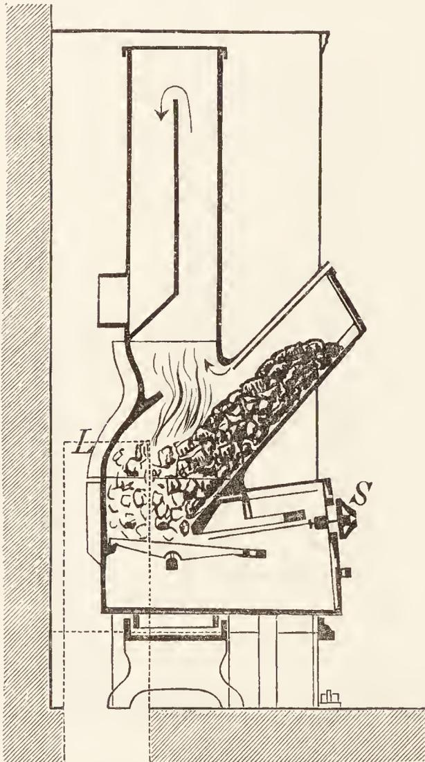
Fig. 63. KÄUFERS Schachtofen, Längsschnitt.
