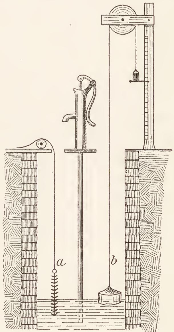
Fig. 6. Grundwassermessung. Schematischer Durchschnitt durch einen Grundwasserbrunnen. Bei *a* Messung mit PETTENKOFERS Schälchenapparat; bei *b* Schwimmer mit oben abzulesendem Zeiger.
