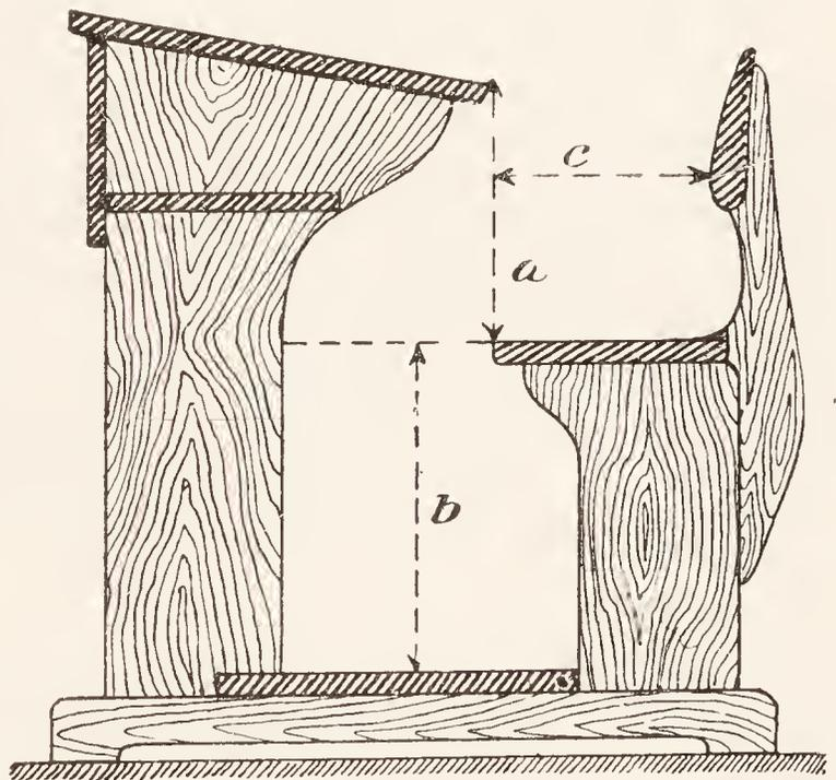
Fig. 122. Schulbank mit Null-distanz (das Lot von dem inneren Tischrand trifft den vorderen Bankrand).
