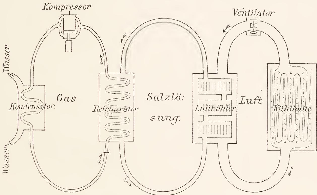
Fig. 41. Schematische Darstellung der Kühleinrichtung für die Kühlhalle.
