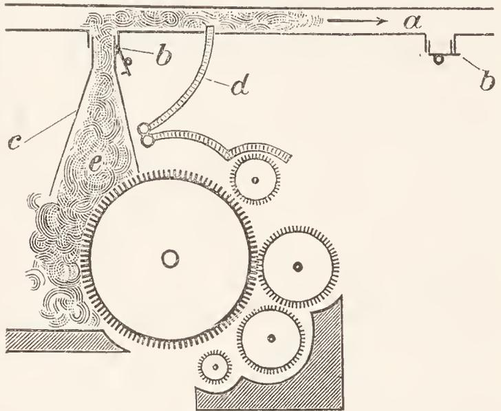
Fig. 138. Staubabsaugung bei der Reinigung der Karden.
