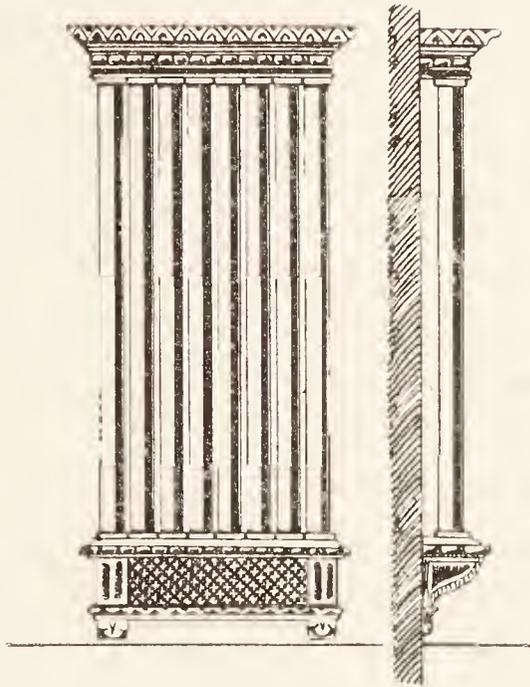
Fig. 74. Doppelrohrregister
