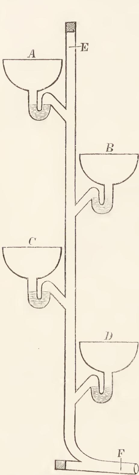
Fig. 98. Schema der Ausgüsse und Syphons eines Hauses.
