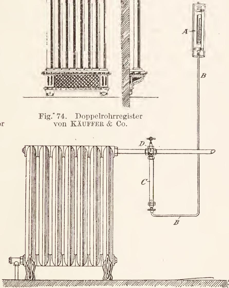
Fig. 75. Heizkörper mit Temperatur.
