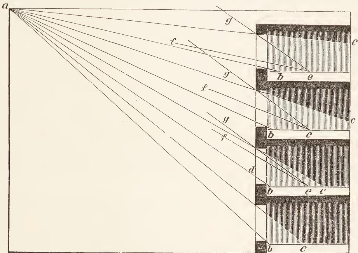
Fig. 84. Tageslichtmessung nach FÖRSTER.
