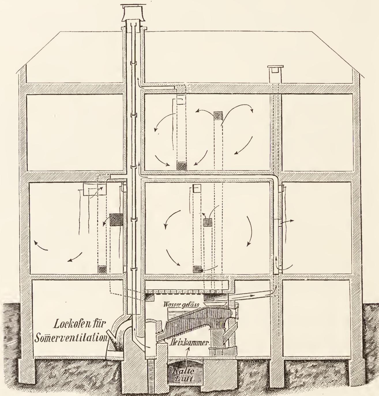
Fig. 69. Schema einer Luftheizungsanlage.
