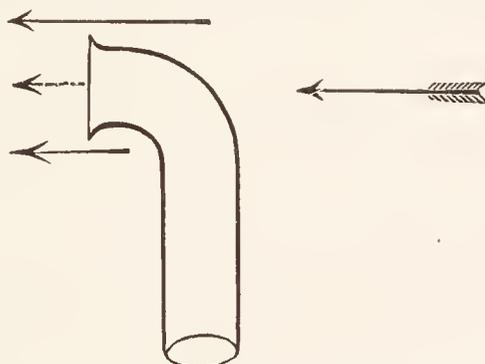
Fig. 81. Aspirationsaufsatz.
