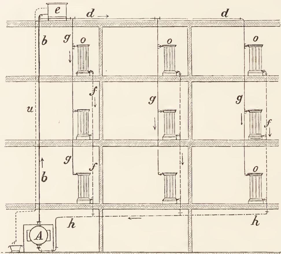
Fig. 71. Warmwasserheizung.
