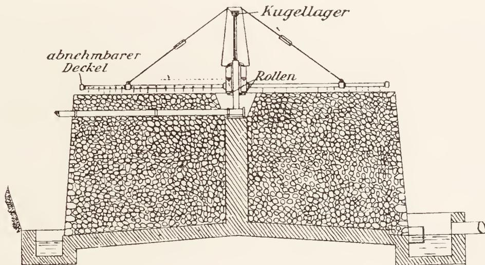
Fig. 111. Offener Tropfkörper mit Drehsprenger ( $\frac{1}{100}$  nat. Größe).
