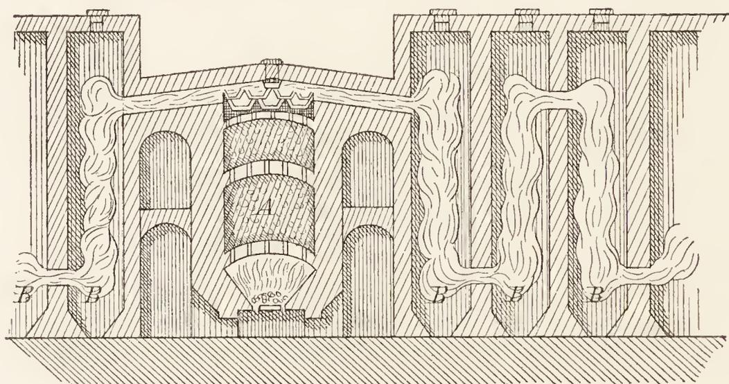
Fig. 139. Röstofen (A) mit Flugstaubkammern (B).
