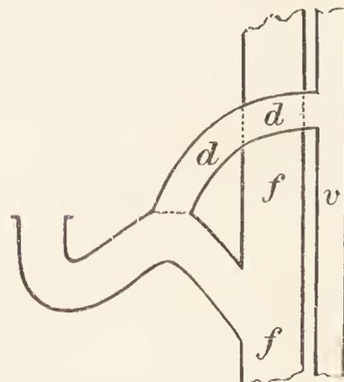
Fig. 100. Schutzvorrichtung an Syphons. Fallrohr. v Ventilationsrohr. d Verbindungsrohr.
