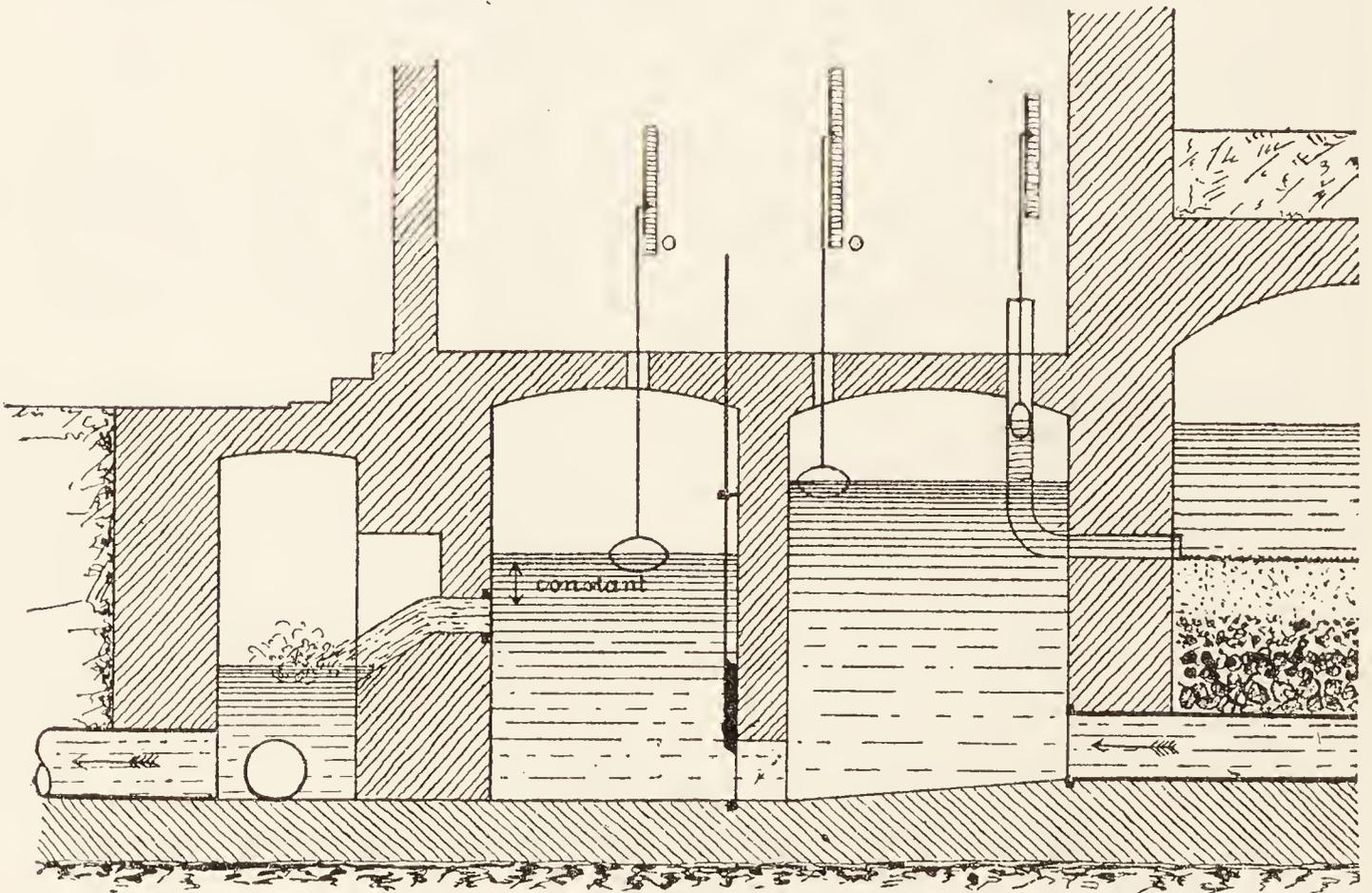
Fig. 24. Filter mit Regulierung nach GILL.
