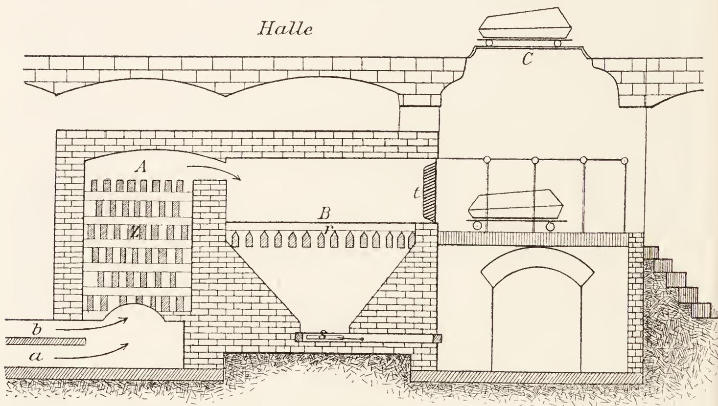
Fig. 119. Schematische Darstellung eines Leichenverbrennungsofens.
