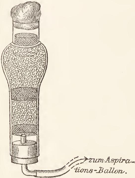
Fig. 5. FICKERsches Filter zur Bestimmung der Luftkeime. 1: 2.
