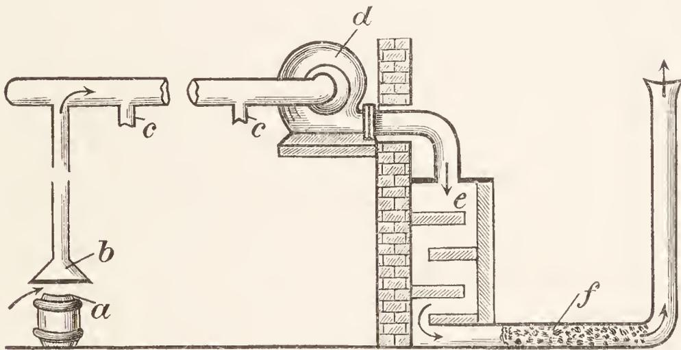
Fig. 140. Absaugung des Bleiweißstaubes.
