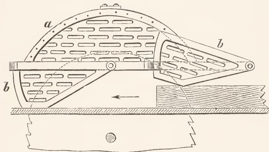
Fig. 141. Schutzvorrichtungen an Kreissägen.
