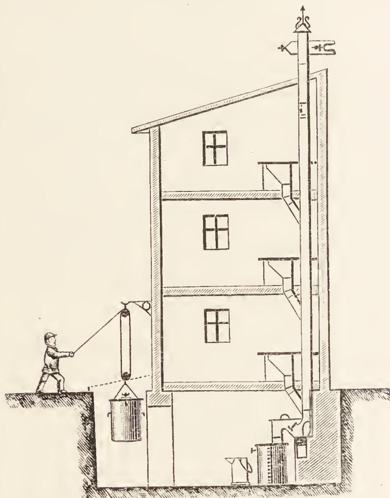
Fig. 92. Profil eines Hauses mit Tonnenabfuhr.
