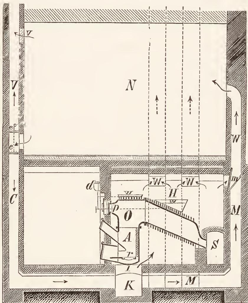
Fig. 70. Luftheizung. Heizkammer und Kanäle.
