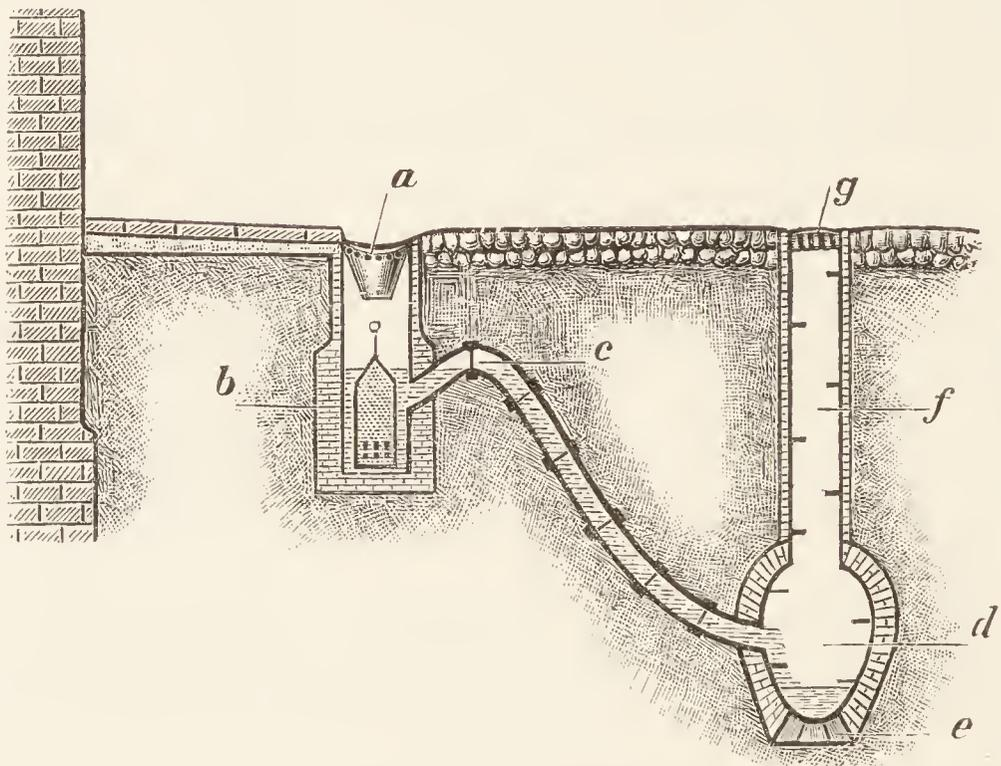
Fig. 95. Profil einer kanalisierten Straße.
