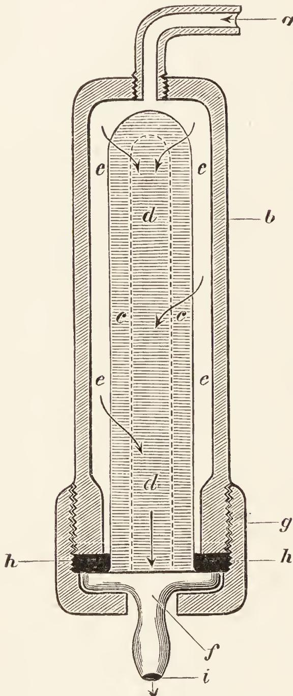
Fig. 28. Ton- oder Kieselgurfilter.
