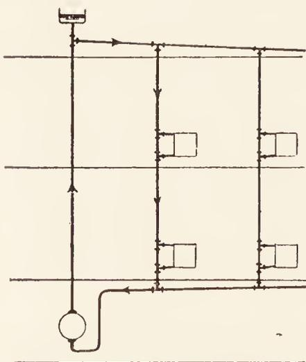
Fig. 72. Einrohrsystem.
