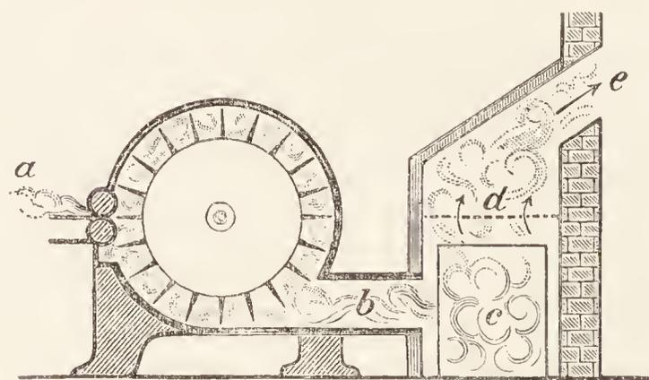
Fig. 137. Reißwolf mit Staubabsaugung.
