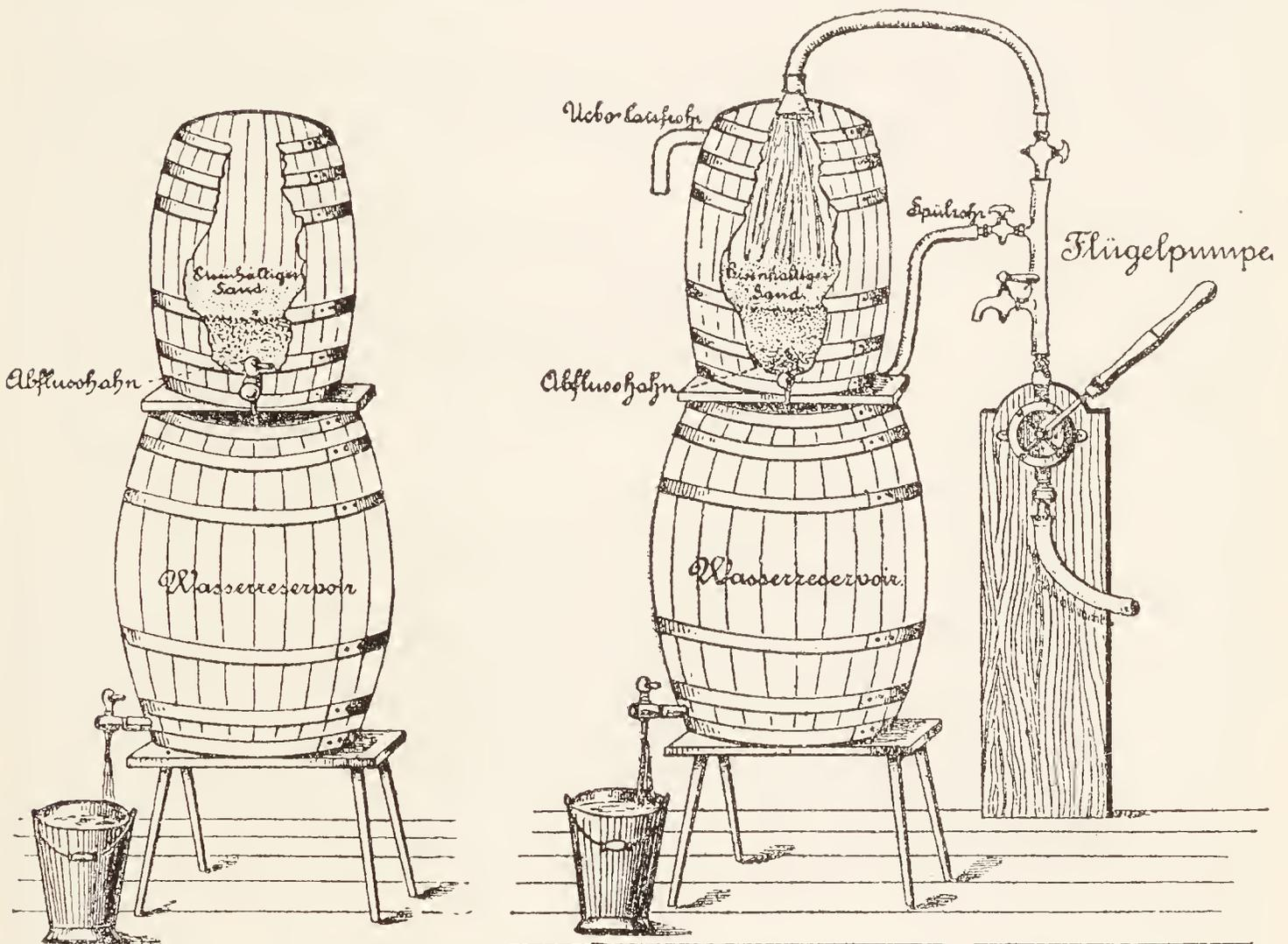
Fig. 20. Enteisung des Wassers bei Brunnenanlagen (nach DUNBAR).
