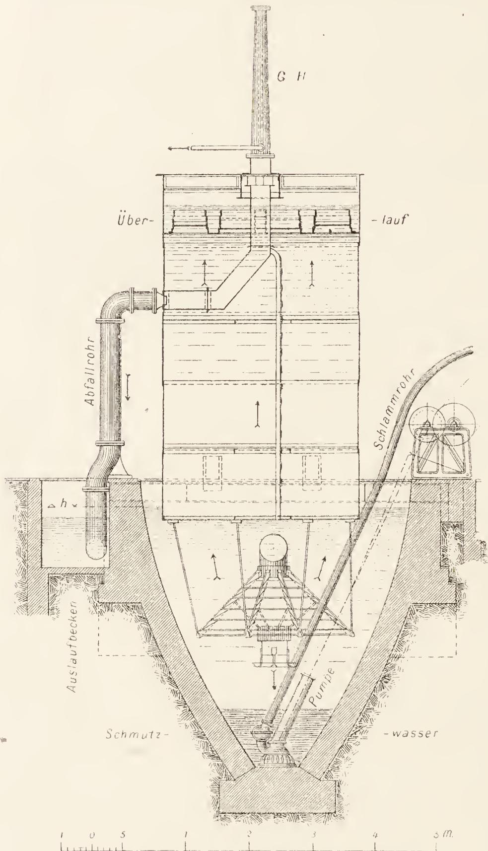
Fig. 108. Klärvorrichtung nach RÖCKNER-ROTHE.
