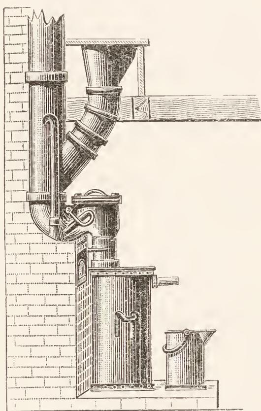
Fig. 93. Heidelberger Tonne, mit Fallrohr, Syphon und Überlaufeimer.
