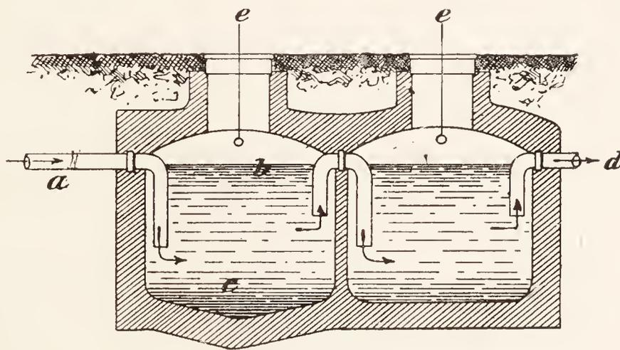
Fig. 109. Faulkammer, schematisch.
