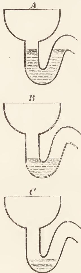
Fig. 99. Verschiedene Füllung der Syphons. A normaler, gefüllter Syphon. B geschwächter Syphon. C leergezogener Syphon.
