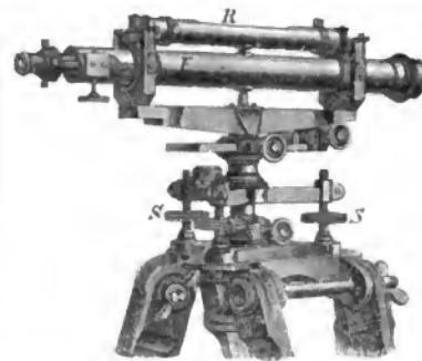
libelle gebildet werden. Bei dem vorstehend abgebildeten Nivellierinstrument ist F das Fernrohr, R die Rechtenlibelle, SSS die zur Horizontalstellung dienenden Schrauben. Auch sind die meistens Theodolitens (s. d.) Theodometer (s. d.) und Kippregeln (s. d.) hierher zu rechnen.
