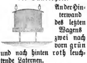
Für einzeln fahrende Locomotiven auf der freien Bahnstrecke genügt eine roth leuchtende Laterne und bei Bewegung der Locomotiven auf Bahnhöfen die Anbringung einer Laterne mit weißem Lichte am Anfange der Locomotive und am Ende des Tenders, bei Tenderlocomotiven an beiden Enden derselben.
