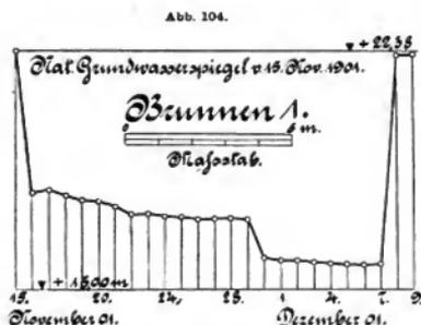
Diagramm der Absenkung des Wasserspiegels.
