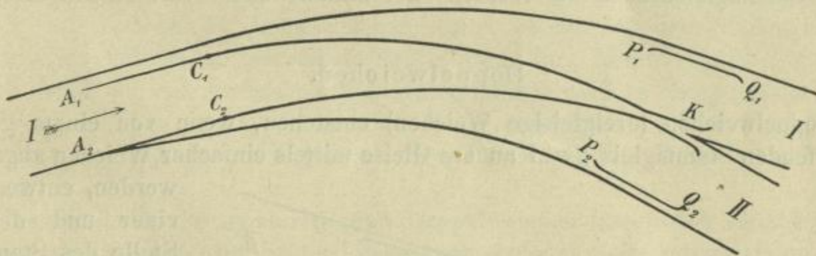
Abb. 4. Einfache Weiche im gekrümmten Hauptgleis.
