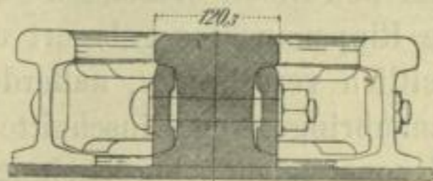
Abb. 55. Schienenherzstück der bayerischen Staatsbahn.
