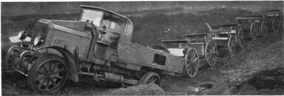
2. Maschinengewehr - Schleppzug auf Steigung mit Winde.
