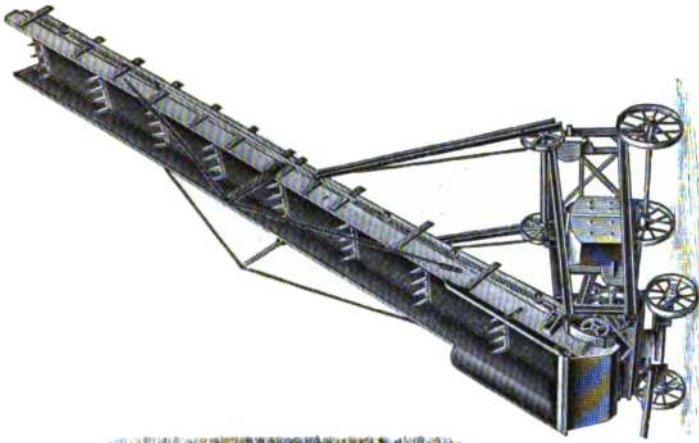
8. Strohelevator, aufgeklappt in Arbeitsstellung.
