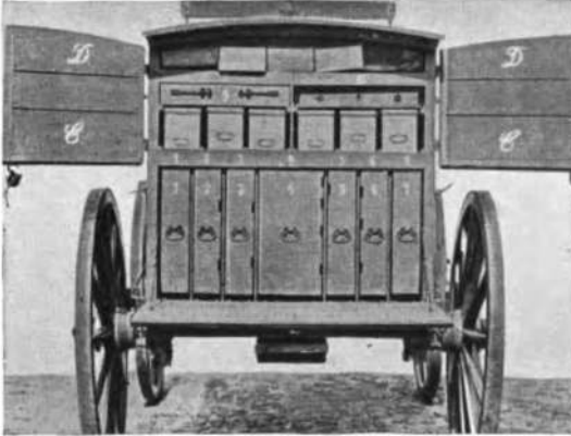
1—4. Sanitätswagen 1895 des Feldlazarets. 1. Geschlossen, 2. Hinterwand geöffnet, 3. und 4. Seitenwände geöffnet.
